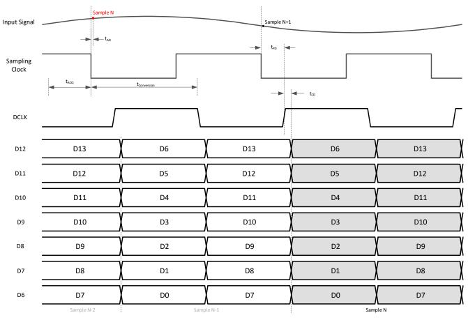
Figure 6-9. Timing Diagram: DDR CMOS
